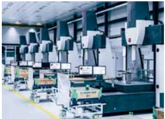
Mehr als Augenmaß — In der Qualitätskontrolle der Bliskfertigung werden rechnergesteuerte optische Messsysteme eingesetzt.
