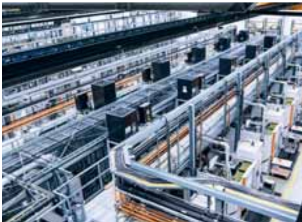
Automatische Bestückung — In der Bliskproduktion bei der MTU in München werden Rohteile direkt zur Bearbeitung in die Maschine eingesteuert, die sich selbst auf das zu bearbeitende Bauteil einstellt.
