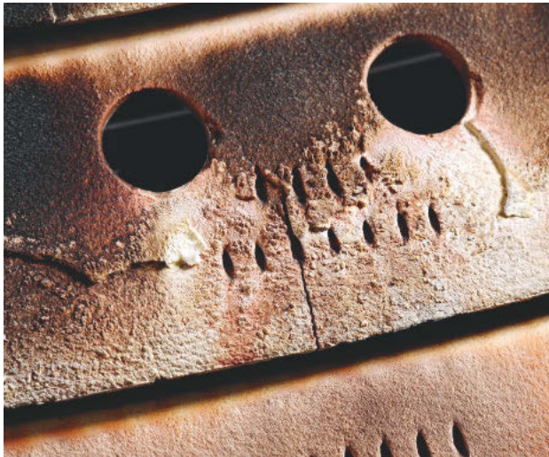
Abgeplatzt _____ Schäden an der Hitzeschutzschicht in der Brennkammer eines CF6-80C2.
