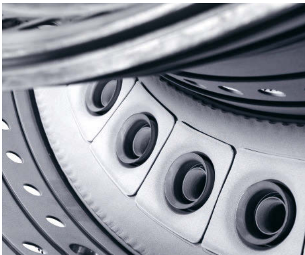
Wieder hergestellt _____ CF6-80C2-Brennkammer mit Thermal Barrier Coating.
