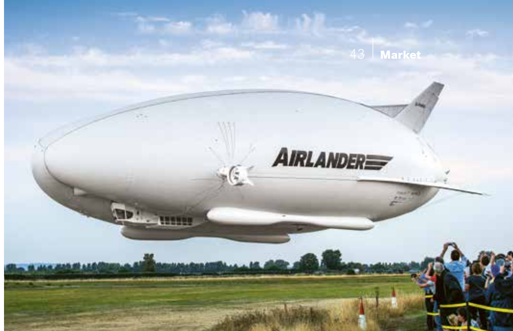
AIRLANDER 10 _____ Einen Teil seines Auftriebs erzeugt das derzeit mit 92 Metern längste Luftschiff der Welt durch seine Form selbst.
