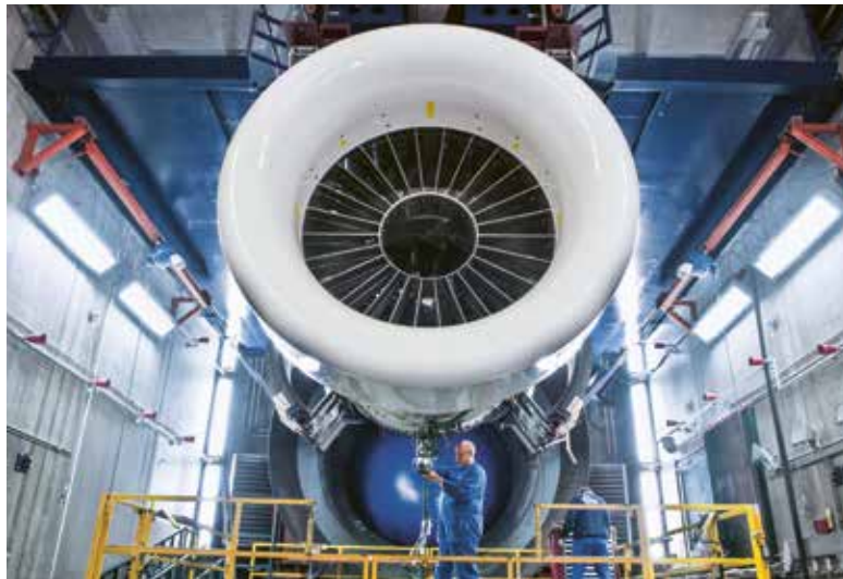
Ein PW1500G, Antrieb für die C Series von Bombardier, auf dem Prüfstand bei der MTU in München.
