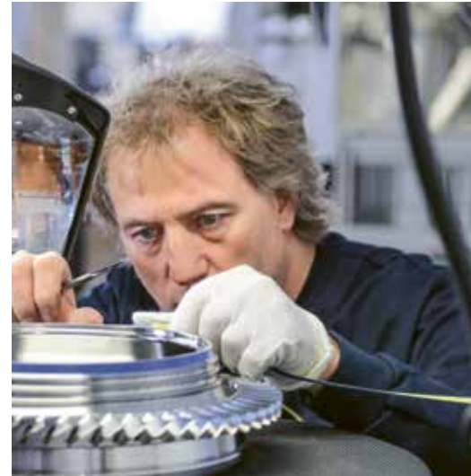
Abkleben einer PW1100G-JM-Hochdruckverdichterblisk vor dem Plasmaspritzen.
