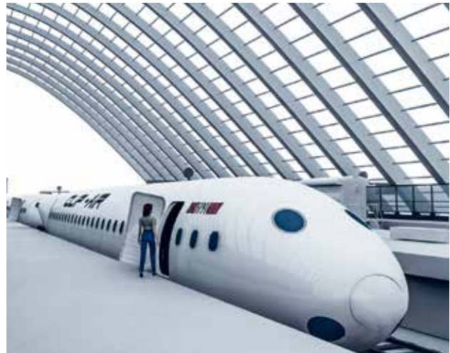
Komfortables Reisen — Die Passagiermodule des Clip-Air-Konzepts können direkt vom Rollfeld auf die Schiene gehen, die Passagiere bleiben entspannt sitzen.
