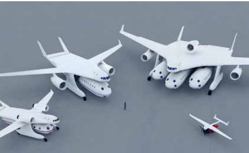
Vielfältiger Nutzen — Beim Clip-Air-Konzept können Module für unterschiedlich große Trägerflieger je nach Bedarf mit Fracht, Passagieren oder Treibstoff gefüllt werden.
