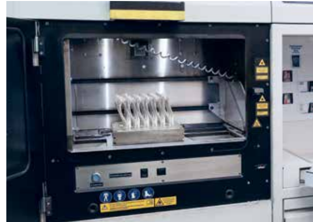
Materialsparendes Verfahren — Fertigung eines Trays von Brackets.
