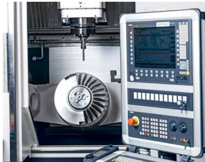
Momentaufnahme _____ Gut zu sehen, wie diese Blisk aus dem vollen Werkstück gefräst wird.
