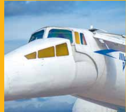
Krumme Nase — Wie bei der Concorde konnte die Spitze der Tupolew Tu-144 am Boden abgesenkt werden, um die Sicht der Piloten zu verbessern.
