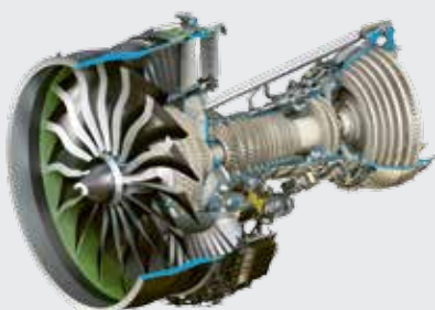
Das Triebwerk der Boeing 777X-9: GE9X-groß und sparsam.
