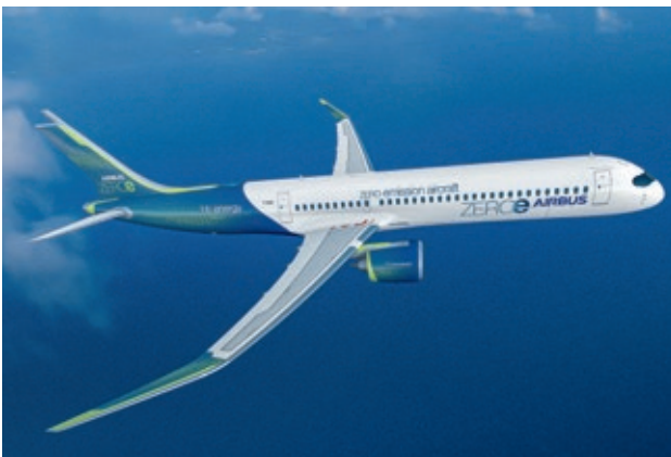
Turbofan-Design — Das Flugzeug für 120 bis 200 Passagiere hat eine Reichweite von mehr als 2.000 Seemeilen.
