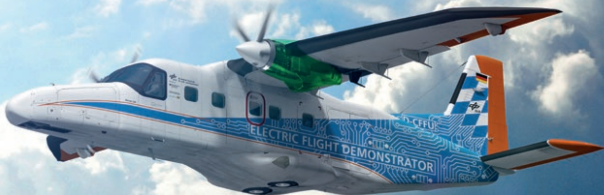
Dornier 228 — Das zweimotorige turbinengetriebene Propellerflugzeug soll als Testflugzeug mit einer wasserstoffbetriebenen Brennstoffzelle ausgerüstet werden.
