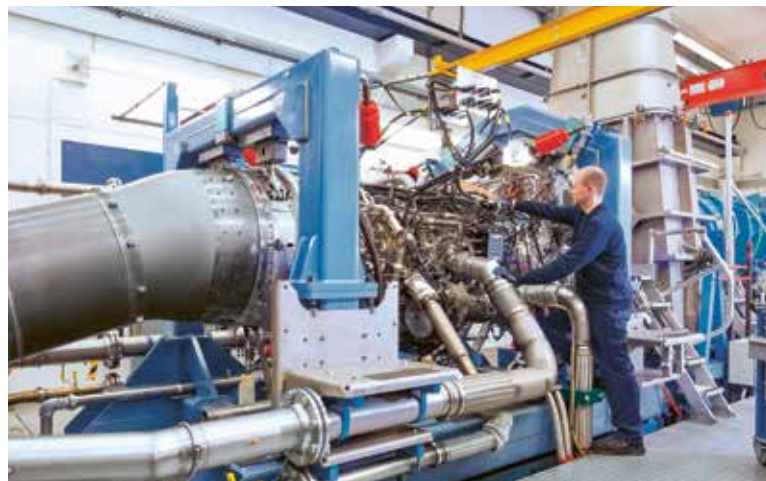
TP400-D6-Serientriebwerke — Die Endmontage erfolgt bei der MTU in München und der Serienabnahmetest bei der MTU Maintenance Berlin-Brandenburg.
