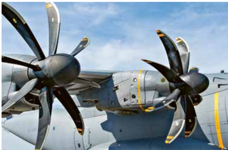
Erstflug — Das TP400-D6 kommt im Militärtransporter A400M zum Einsatz, der Ende 2009 im spanischen Sevilla seinen Erstflug absolviert hat.
