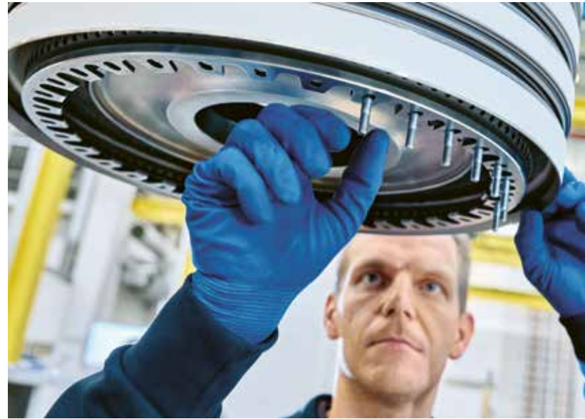
Einrüsten – Teil 2 — Im zweiten Schritt wird die hintere Verdichtertrommel für den Verschraubungsprozess vorbereitet.
