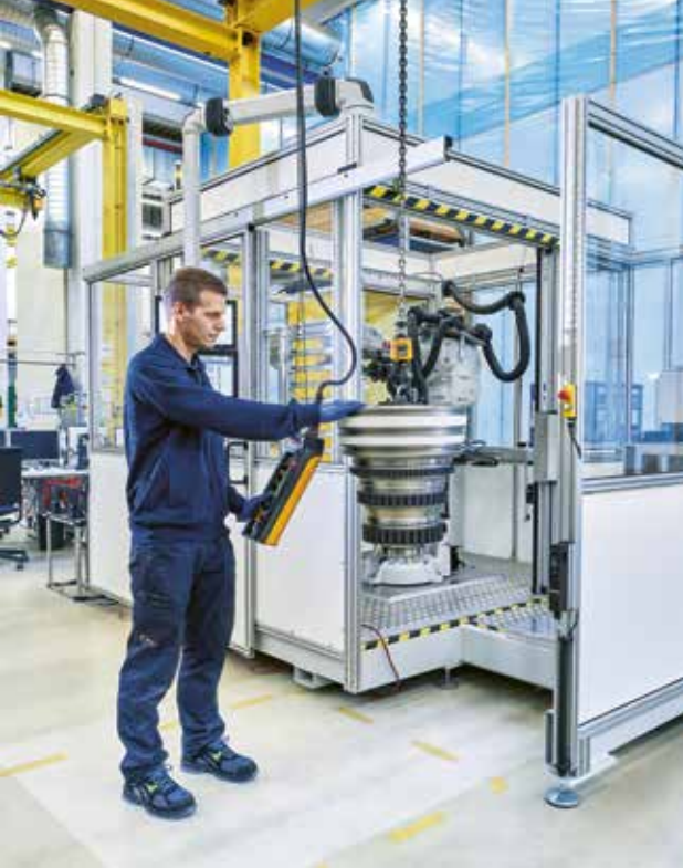
Einrüsten – Teil 1 — Zunächst wird die vordere Verdichtertrommel eingerüstet.
