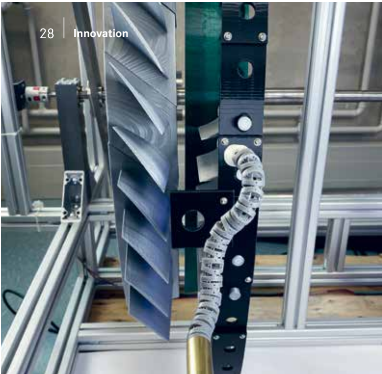
Forschung im Labormaßstab — Experimente mit dem RoBokop an einer Stufe eines Hochdruckverdichters. Das Modell ist um den Faktor 2,5 hochskaliert, um die Durchführung von Versuchen zu erleichtern.
