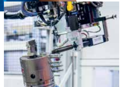
Automatisierte Fertigung — Hochdruckturbinenschaufeln werden bei der MTU zum Teil auch vollautomatisiert gefertigt.
