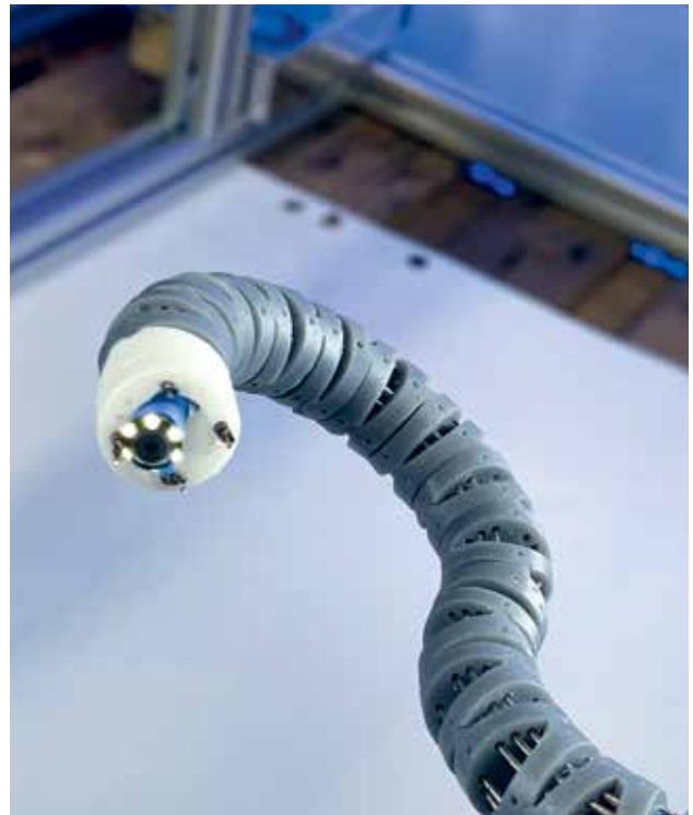
Klein und flexibel — Durch das Innere des Miniatur-Roboters führen Kabel und Leitungen für die Kamera und das Messsystem. Der RoBokop wird miniaturisiert und dann einen Durchmesser von nur sechs Millimetern haben.
