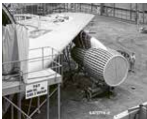
Holzattrape des JT9D — Das Triebwerk von Pratt & Whitney war das erste Strahltriebwerk mit hohem Nebenstromverhältnis, das ein Großraumflugzeug antrieb.
