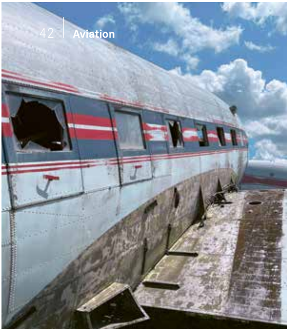
Keine Tragflächen, Beulen im Rumpf — Kaum zu glauben, dass aus vermeintlich schrottreifen, bis zu 80 Jahre alten DC-3 bei Basler wieder nagelneue Flugzeuge werden.
