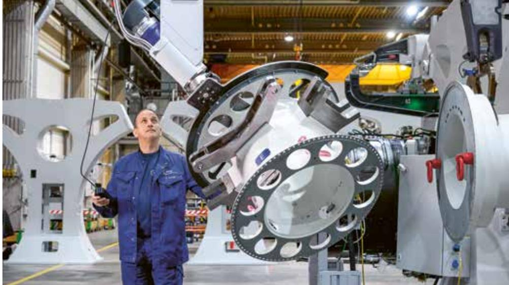
**Intelligenter Greifarm** — Der Smartlifter macht seinem Namen alle Ehre. Er erkennt automatisch, welches Modul er gerade greift und welches Tooling dafür verwendet wird.
