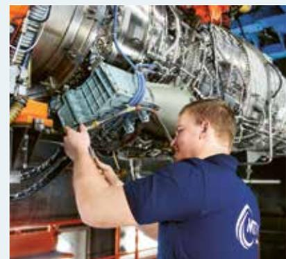
**Gehirn des Triebwerks** — Die DECMU ist am vorderen Ende des Triebwerks befestigt. Dort führen zahlreiche Leitungen dem System Informationen zu, die in einer Box, nicht größer als ein Schuhkarton, verarbeitet werden. Alles, was die Steuerung des Antriebs betrifft, läuft über den voll digitalen Regler.
