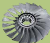
**Als sich Schaufel und Scheibe fanden** — Die MTU-Ingenieur:innen leisteten mit der Einführung sogenannter „Blade Integrated Disks“ (Blisks) Pionierarbeit. Im EJ200 fanden sich erstmals solche in ganzen sechs Verdichterstufen.
