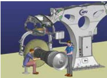
**Dritter Schritt** — Mechaniker:innen können durch die Höhenverstellbarkeit nun ergonomisch am Triebwerk arbeiten.
