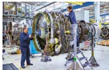
**CFM56-7B** — Das stark eingesetzte Triebwerk wird nun auch bei der MTU Maintenance in Ludwigsfelde instandgesetzt.
