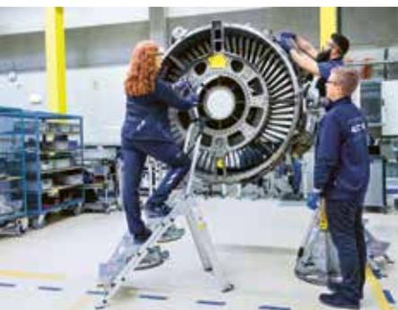
**Theorie und Praxis** — Bei der DAT-Schulung werden die Basics zur Triebwerksdemontage und -montage sowie zum Triebwerkstest vermittelt.
