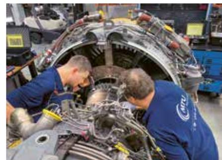
**Volle Konzentration** — Die Reparatur am Hochdruckverdichter ist hochkomplex. Sven Zimmermann schult seinen australischen Kollegen in dieser Disziplin an einem CF34.
