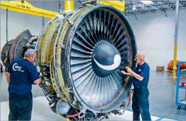
Bewährte Technologie ____ Ein CF6-80C2 in der Instandhaltung bei der MTU Maintenance.
