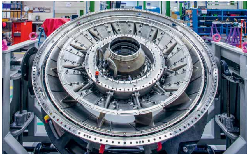
High-Tech-Fertigung — Montage eines GENx-Turbinenzwischengehäuses.
