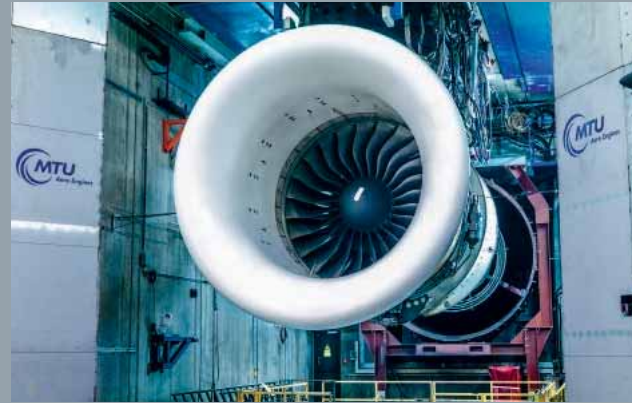
Gigant im Test ____ Ein GP7000 auf dem Prüfstand.
