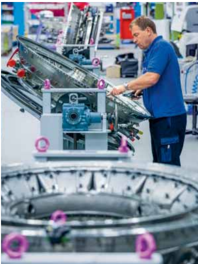
High-Tech-Fertigung — Montage eines GENx-Turbinenzwischengehäuses.
