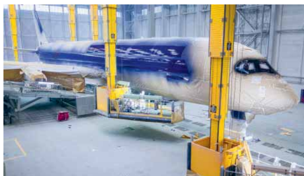
Decklack _____ Farbe bekommt das Flugzeug mit der dritten Lackschicht, hier bei Airbus.
