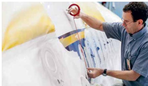
Passgenau _____ Ein Mitarbeiter von Lufthansa Technik beim Abkleben des Fensters der D-AIRX, einer Airbus A321-131, die 2013 zum fünfzigjährigen Jubiläum der Lufthansa im Look der frühen 1950er Jahre lackiert wurde.
