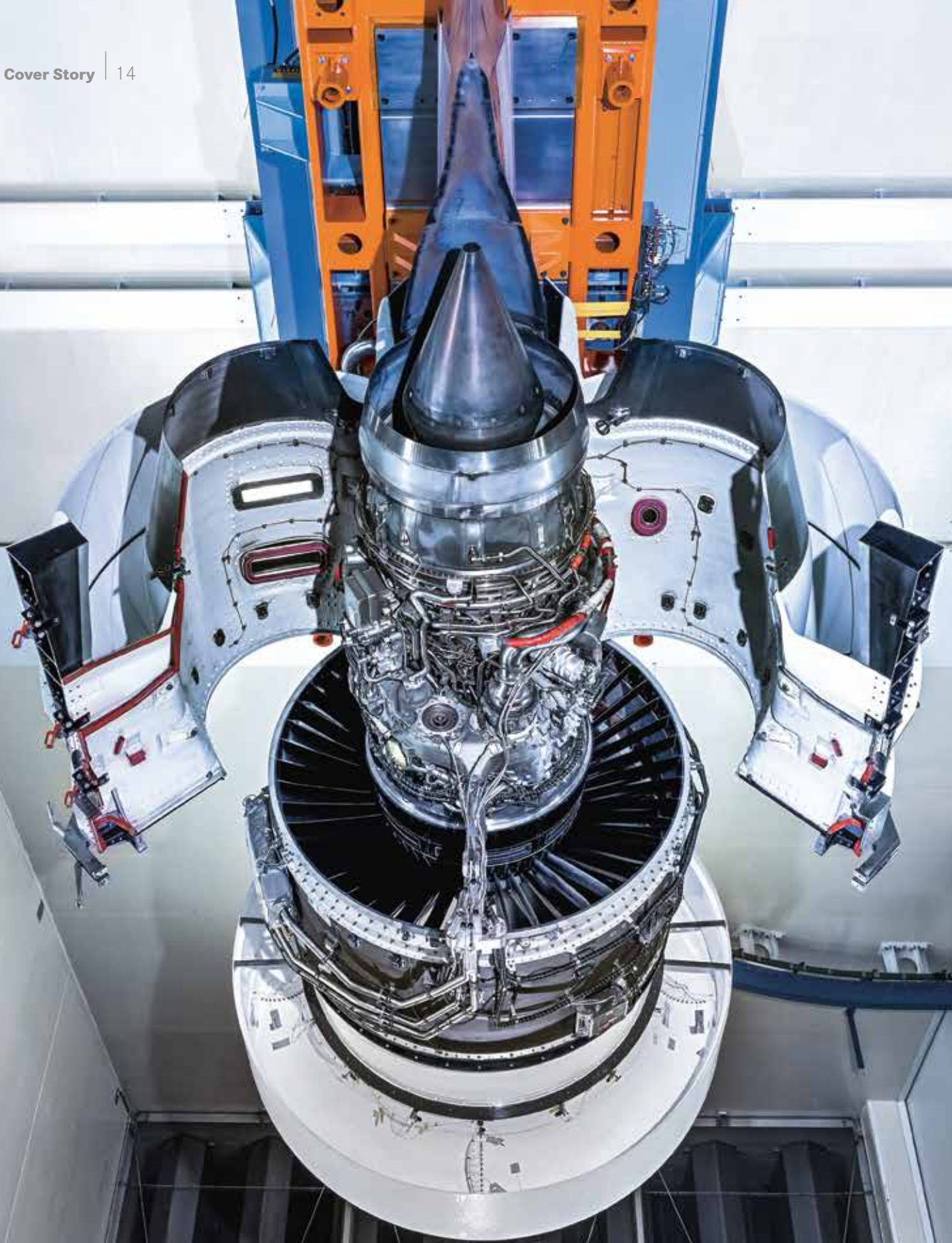
Eindrucksvoll Ein PW1100G-JM am Prüfstand bei der MTU Maintenance Hannover. Ein Drittel aller PW1100G-JM weltweit werden bei der MTU montiert und anschließend auf den Prüfständen in München und Hannover getestet.
