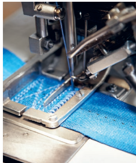
High-Tech-Band — Sicherheitsgurte im Flugzeug müssen nicht nur hohe Zugkraft haben, sondern auch lichtbeständig, säureresistent, schwer flammbar und formstabil sein. Dazu tragen neben dem Fasermaterial spezielle Web- und Nähtechniken bei.
