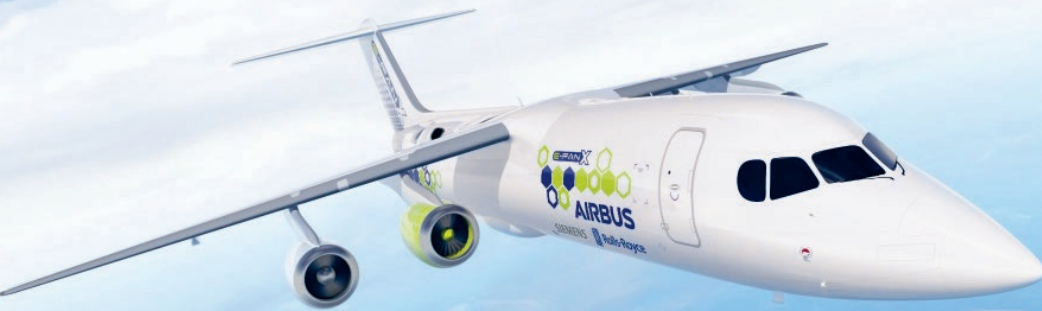
E-Fan X — Bei dem vierstrahligen Prototyp wird zunächst nur eines von vier Triebwerken durch einen Elektroantrieb ersetzt.
