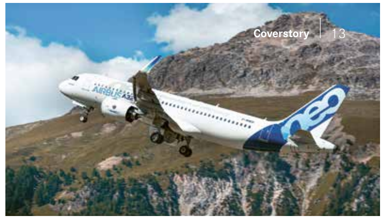
A320neo — Das Flugzeug zeichnet sich durch neue Triebwerke und eine verbesserte Aerodynamik aus. Der Zusatz „neo“ steht für „New Engine Option“.
