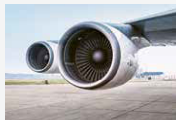
Antrieb für Jumbo Jet — Zwei CF6-80C2 Triebwerke am Flügel einer Boeing 747.
