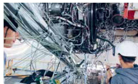
Ausstattung mit Sondermesstechnik — Auf dem Prüfstand der MTU führten die Forschungsteams der Universitäten verschiedene Tests an einem V2500-Triebwerk durch.
