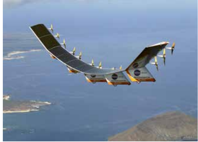
Prototyp „Helios“ — Die solarenergie-betriebene HAP wurde von der NASA entwickelt und erreichte 2001 mit 29.413 Metern den Weltrekord für maximale Höhe. Für 40 Minuten hielt sich die Plattform in der Luft.
